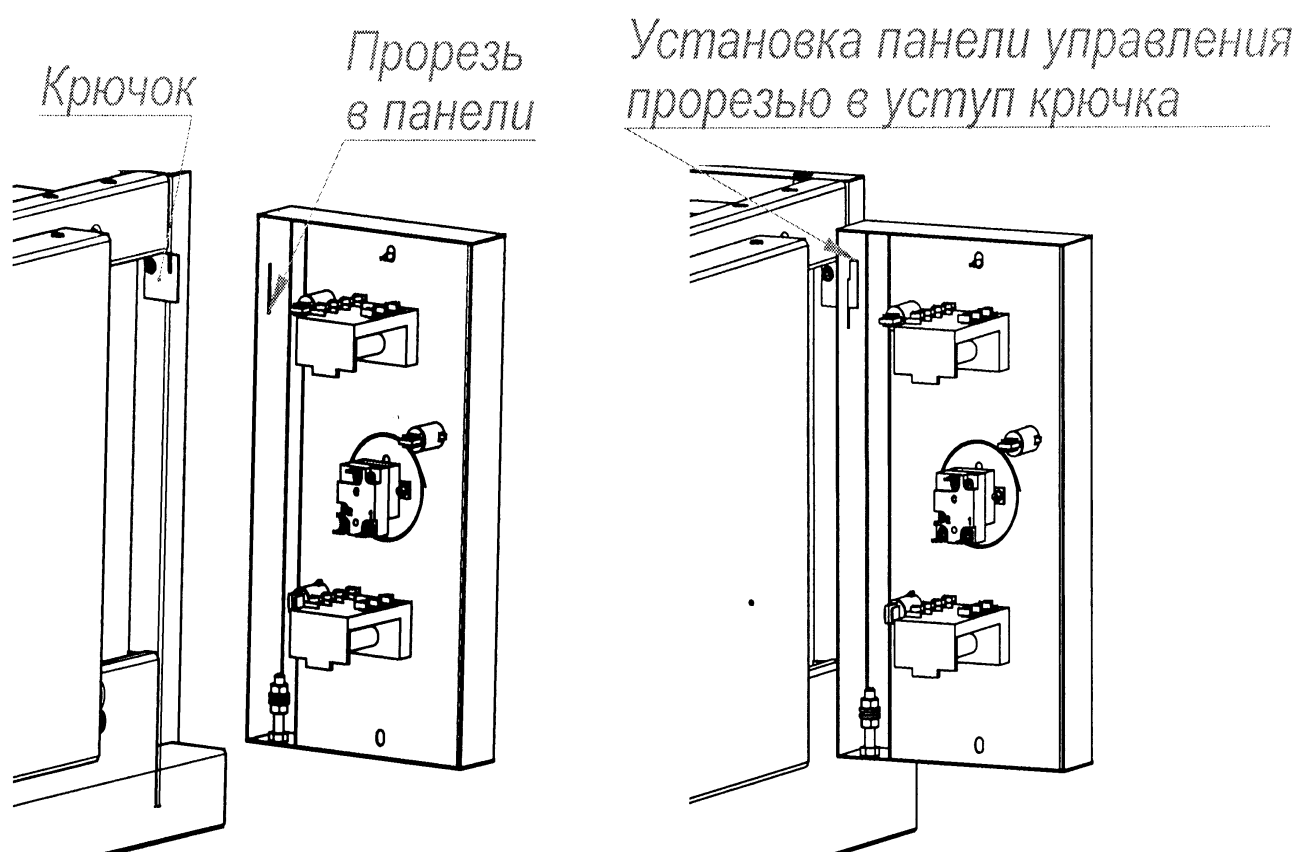
Рис.6 Схема установки панели управления при ТО
